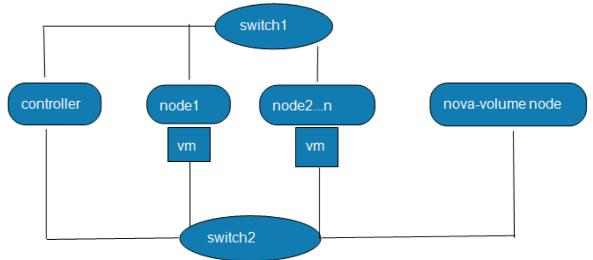
上图是个简单的拓扑图。每台 host 都有两块网卡,连接 switch1 的是外部访问接口,就是用户可以直接连接到的 ip 网络,这个网络用来提供给虚拟机以使用户使用。switch2 使用一个内部的网络,即对用户不可见,我们可以设定一个私有网络,这个网络用来 node 节点和 controller 之间的网络通讯, image 的传输, nova-volume 和 node 之间的 iscsi 的数据传输。
