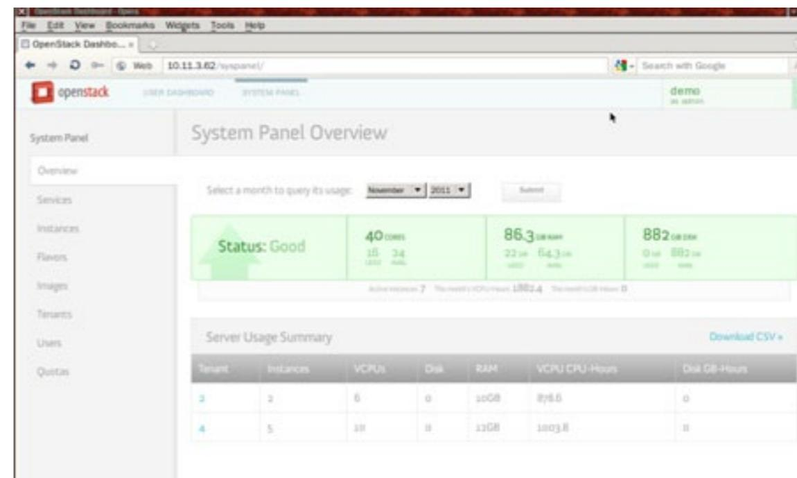
这样图中显示的 40 cores 就是总共的 cpu,已经用了 16 个 ;第二列是内存,下面显示了有两个部门。分别跑了 2 个和 5 个实例。
